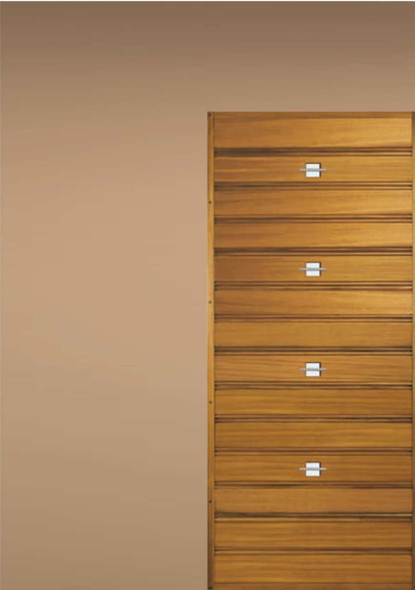
MT07 - teak naturale finitura ad olio spessore 15 mm con chiodi in legno e inserti in acciaio e vetro
